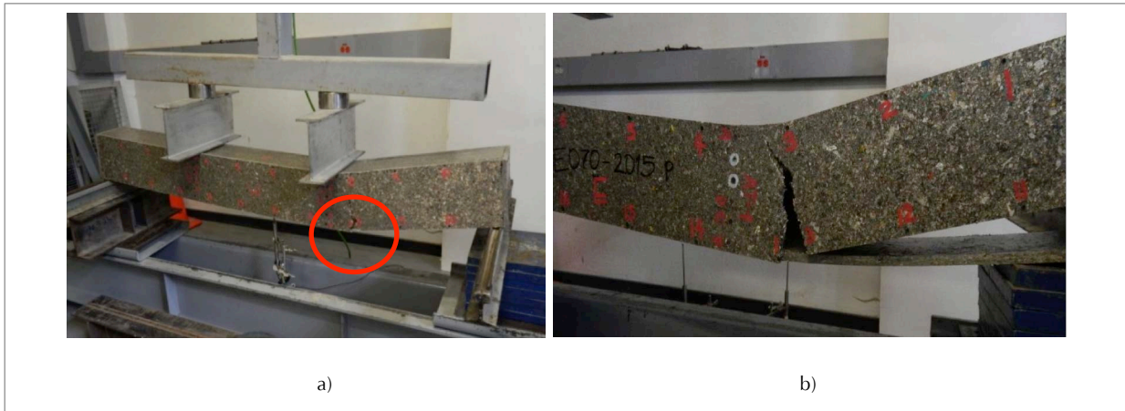
Figura 6. a) Elemento estructural hueco en Tetra Pak reciclado con grieta típica que comienza en el tornillo inferior, b) Viga con falla en su estado final, donde la grieta avanza en el costado sometido a compresión de la sección lateral
