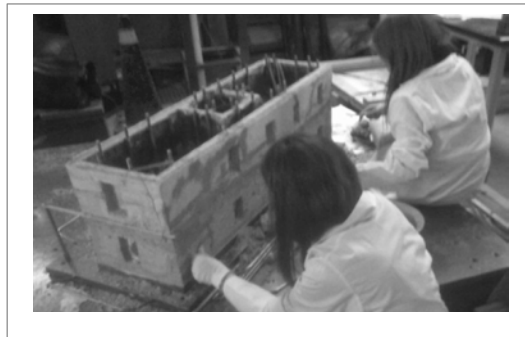
Figura 17. Proceso de apertura de puertas y ventanas
