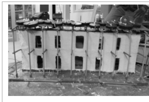
Figura 18. Modelo sin refuerzo antes de la falla
