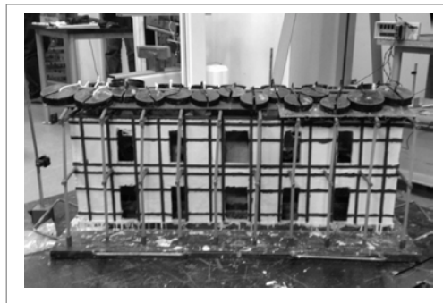
Figura 22. Modelo reforzado con cargas antes del sismo
