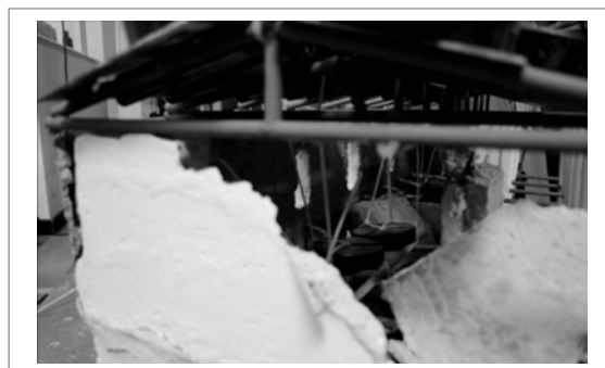
Figura 31. Colapso de la escalera en el segundo piso
