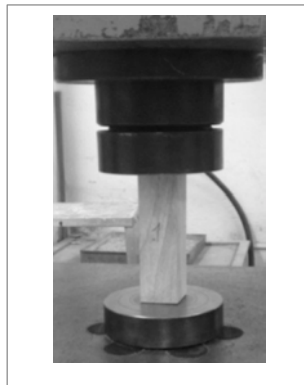
Figura 7. Montaje de probetas a compresión sobre la máquina universal
