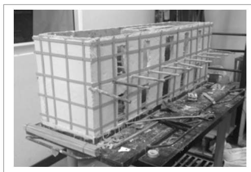
Figura 19. Colocación de la madera de refuerzo
