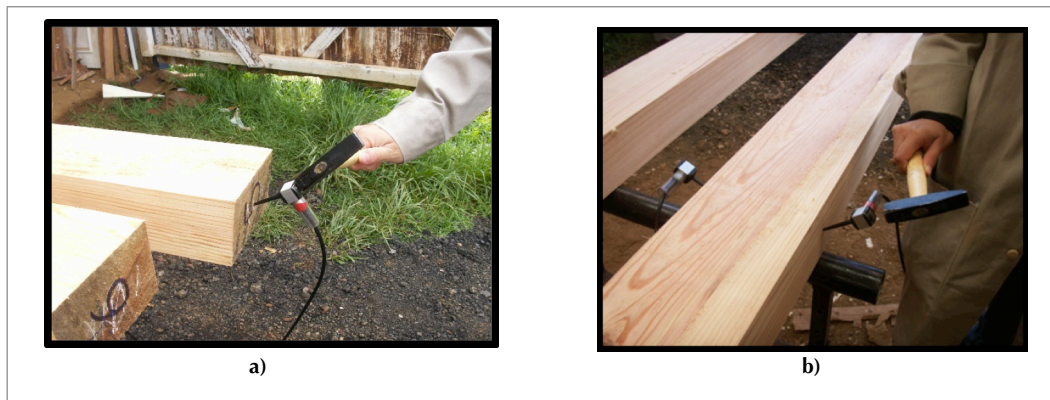
Figura 1. Medición del tiempo de transmisión de las ondas de esfuerzo en las vigas. a) Dirección longitudinal, b) Dirección transversal Figure 1. Measurement of the transmission time of the stress waves in beams. a) Longitudinal direction, b) Cross-section direction
