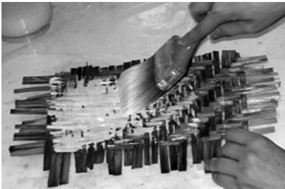
Figura 2. Aplicación de adhesivo PVA
