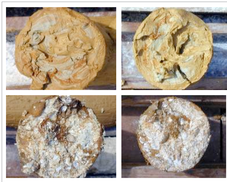
Figura 14. Muestra del elemento ingeniero- geológico No. 4 Figure 14. Sample of engineering-geological element Nr. 4
