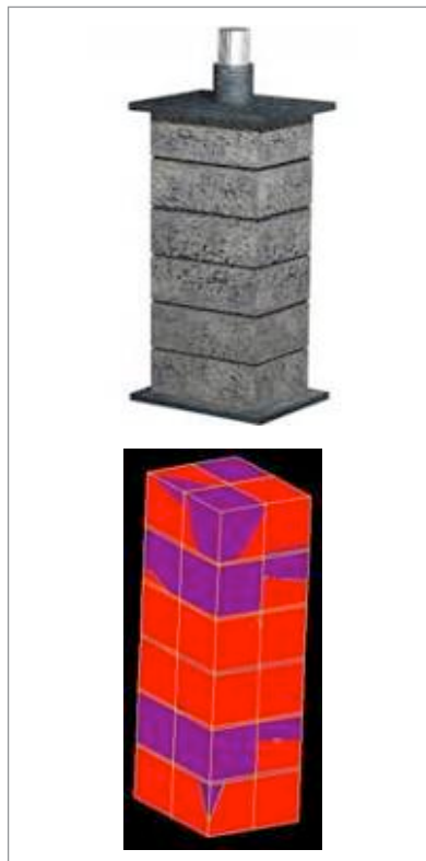
Figura 8 Modelación virtual del ensayo a compresión simple Figure 8. Virtual modelling of simple compression test
